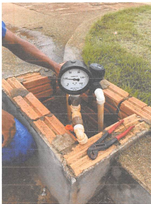
Figura 10 - 30 mca de pressão na Av. Santa Catarina – Unidade de Saúde da Família II. (Data: 12/11/2019).
