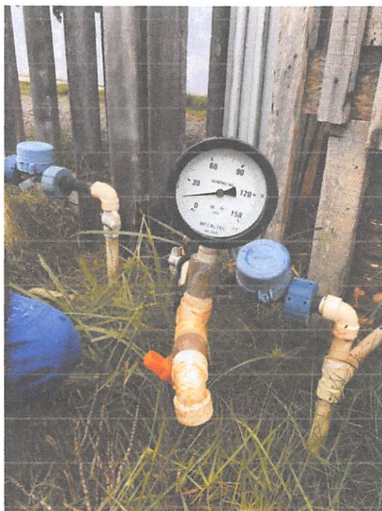
Figura 09 – 14 mca de pressão no ponto mais crítico de União do Sul. (Data: 12/11/2019).
