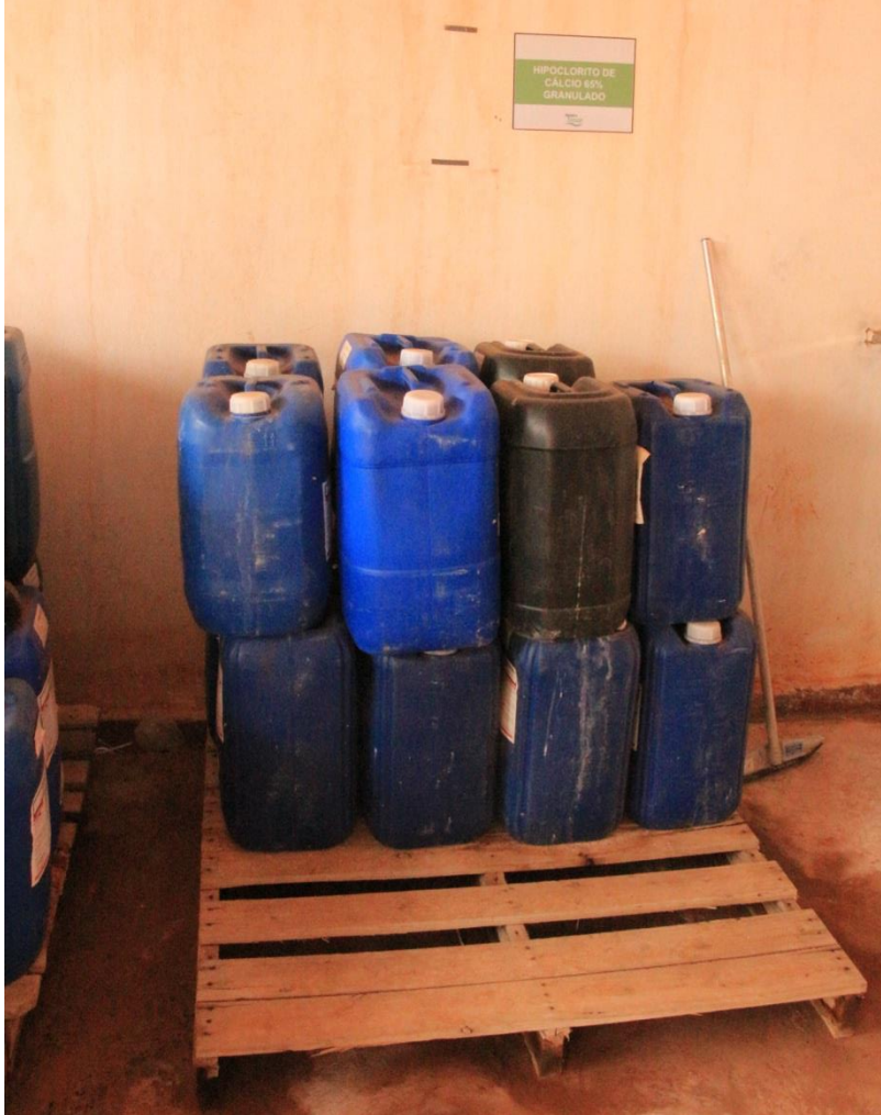
Figura 32 – Identificação incorreta dos produtos químicos (Data:26/09/2019)
